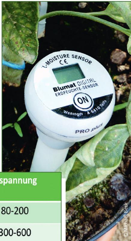
Bodenfeuchtesensor zur Messung des Bodenwassergehaltes
